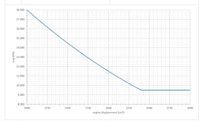
Aux fins de l'utilisation du graphique, la cylindrée du moteur de la To use the graph, the car engine displacement must be rounded to inférieurs, ne doit être supérieur à la valeur fixée pour la cylindrée displacement. correspondante.
